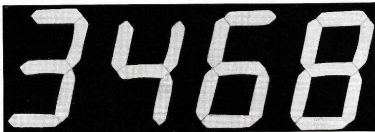
Bild 3: Elektrolumineszenzanzeige
